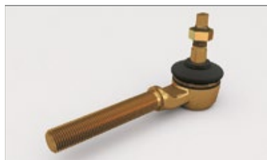
Хвостовик 362-1703420 (длинный L=120мм) 362-1703420-20 (короткий L=75мм)
